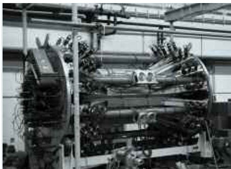
The DAPHNE (Détecteur à grande acceptance pour la physique photo-nucléaire Expérimentale) detector at the Mainz Microtron in Germany, where Canadian physicists study photoproduction of nuclear resonances.
